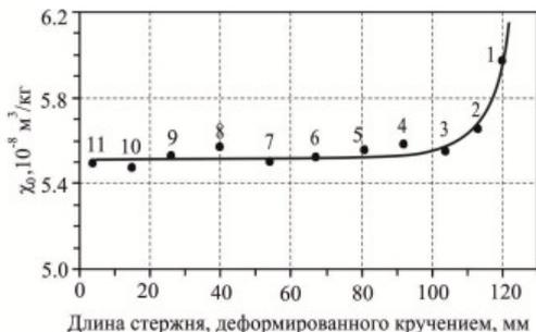
**Рис. 1.** Распределение удельной магнитной восприимчивости парамагнитного аустенита по длине стержня после деформации кручением. Цифрами указаны номера вырезанных образцов.
