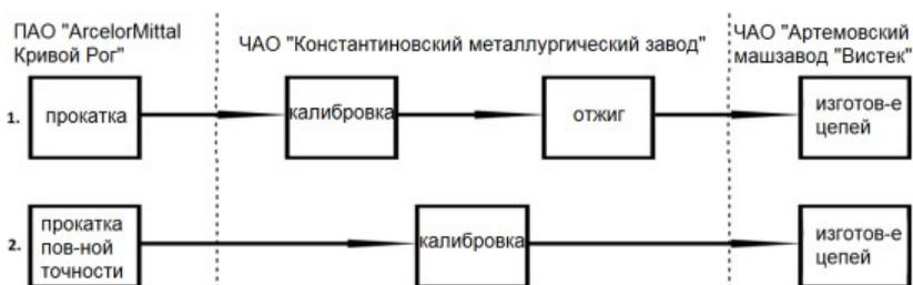
Рис. 2. Схемы изготовления цепей класса С с калиброванного металла
