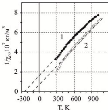
Рис. 3. Температурная зависимость обратной удельной магнитной восприимчивости аустенита исследуемой стали до (кривая 1) и после (кривая 2) пластической деформации кручением.
