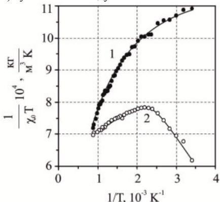
Рис.4 Зависимость  $1/(\chi_0 \cdot T)$  от  $1/T$  аустенита исследуемой стали до (кривая 1) и после (кривая 2) пластической деформации кручением.
