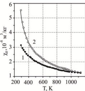
Рис. 2. Температурная зависимость удельной магнитной восприимчивости аустенита исследуемой стали до (кривая 1) и после (кривая 2) пластической деформации кручением.
