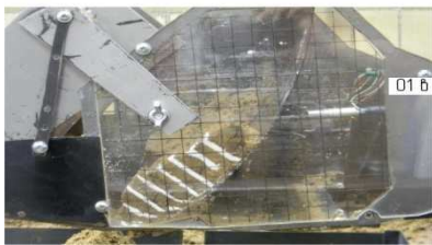
Рис.3. Фотограммы ковшей скреперов 01а,б,в – ковш с полукруглым днищем и разгрузкой маятникового типа; 02а,б,в – ковш традиционного типа.
