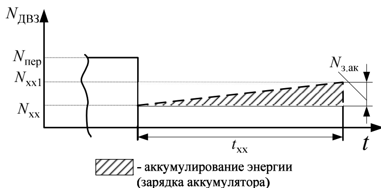
Рис. 4. Режим холостого хода бульдозера с возможностью аккумуляции энергии: N_{з.ак} – мощность, затрачиваемая на зарядку ГПА; N_{хх1} – мощность, затрачиваемая двигателем на режиме холостого (обратного) хода при зарядке аккумулятора.
