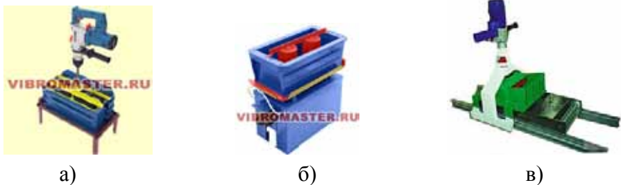
Рис. 3. Мобільні станки для формування будівельних виробів та їх обладнання: а – ударної дії; б – форма для сировини; в – для технології зонного нагнітання МН-0,5 («Русские качели»)
