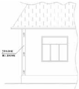
Рис. 6. Общий вид усиления углов саманного здания уголками из досок
