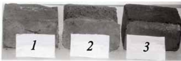
Рис. 3. Образцы из виброуплотненного и вибровакуумированного золобетонa после 8-ми циклов испытаний: 1, 2 – виброуплотненные образцы из жесткой бетонной смеси; 3 – вибровакуумированный образец
