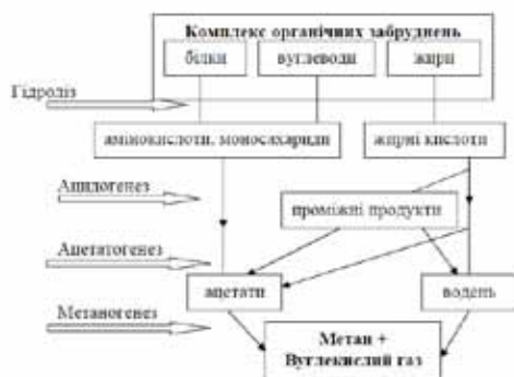
Рис. 1. Схема анаеробного розкладання органічних речовин у стічних водах[3]
