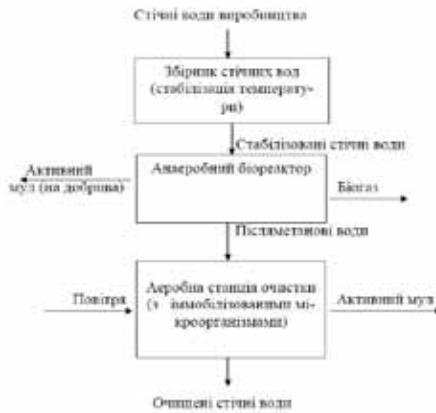
Рис 2. Принципова схема матеріальних потоків при біологічній очистці стічних вод[4]
