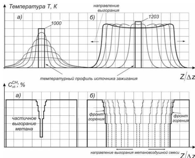
Рис. 8. Динамика температурного профиля  $T$  и объемной доли метана  $C_{CH_4}^{vol.}$  в численном решении задачи: а) частичное воспламенение без горения, б) зажигание и горение метана / The temperature profile  $T$  and the volume fraction of methane  $C_{CH_4}^{vol.}$  in the numerical solution of the problem: a) partial combustion, no combustion, b) the ignition and combustion of methane
