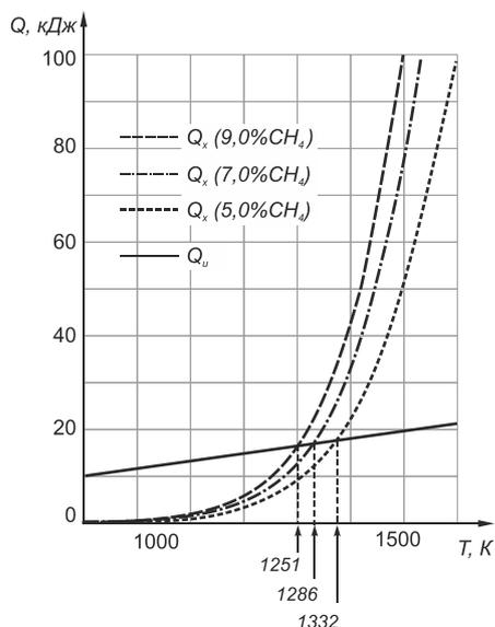
Рис. 6. Определение температуры зажигания по зависимости теплоприхода источника зажигания  $Q_u$  и химической реакции  $Q_x$  от начальной температуры / Determination of ignition temperature depending on teploprihoda ignition source and a chemical reaction  $Q_u$  and  $Q_x$  the initial temperature
