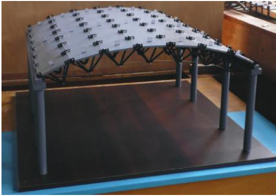
Рис. 2. Модель структурно-вантової циліндричної оболонки
