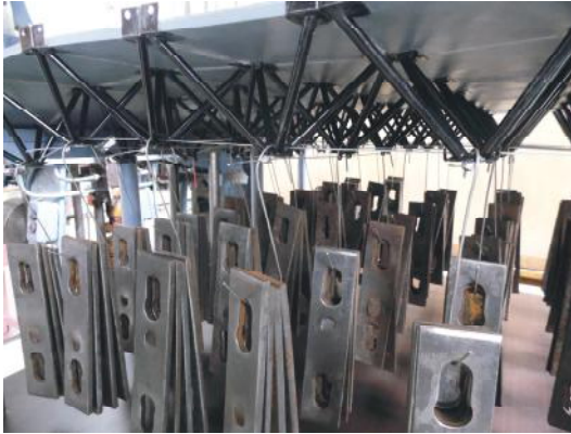
Рис. 4. Вузлове завантаження по нижньому поясу
