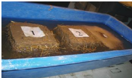
Рис. 2. Вид образцов самана и глины при испытании в воде а) – образцы перед испытанием; б) – вид образцов через сутки испытаний; в) – то же через трое суток.
