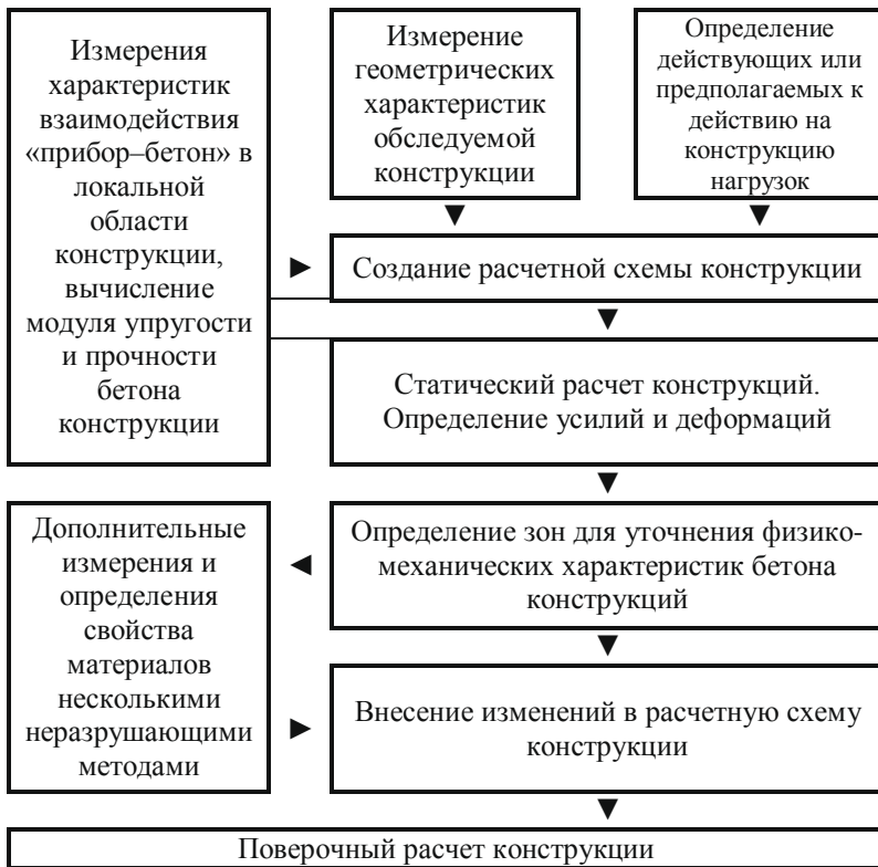
Рис. 2. Схема выполнения операций для осуществления поверочного расчета с использованием результатов определения прочности бетона методами неразрушающего контроля
