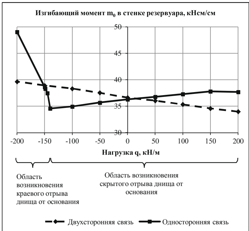
Рис. 1. Зависимость m_0 от величины нагрузки q при коэффициенте постели C1 = 1 \text{ кН/см}^3
