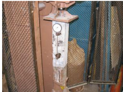
Рис. 5 Призма в специальной установке при длительных испытаниях
