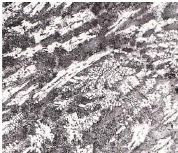
Рис.4. Микроструктура сплава Fe-B-C, наплавленного с частотой колебаний 100 Гц и амплитудой 1 м,  $\times 100$
