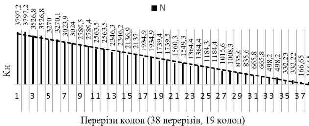
Рис. 5. Приріст поздовжніх сил у сусідніх колонах
