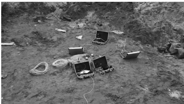
Рис. 2. Розміщення акселерометрів № 4, № 5 на палі № 1 та акселерометрів № 6, № 7 і № 8 на ґрунті біля
