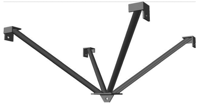
Рис. 2 – Просторова решітка / Space grid
