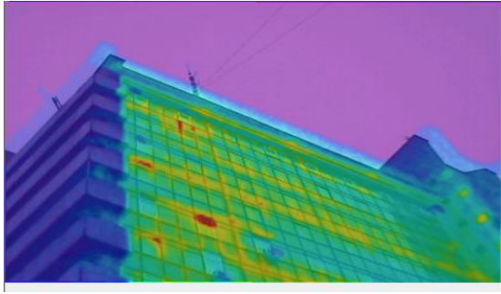
Рис. 6. Накладення ІК-зображення на реальну фотографію частини зовнішньої стіни будівлі ДВНЗ ПДАБА / Fig. 6. Imposition of infrared images on real photo of the exterior wall of the building SHEE PSABEA
