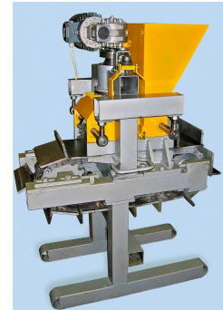
Рис. 4. Формування будiвельних виробiв зонним нагнiтанням сировини:
