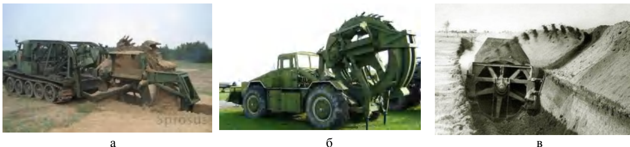
Рис. 4. Машини для виконання траншей: а, б – багатокішцеві екскаватори; в – роторно-металеві машини.
