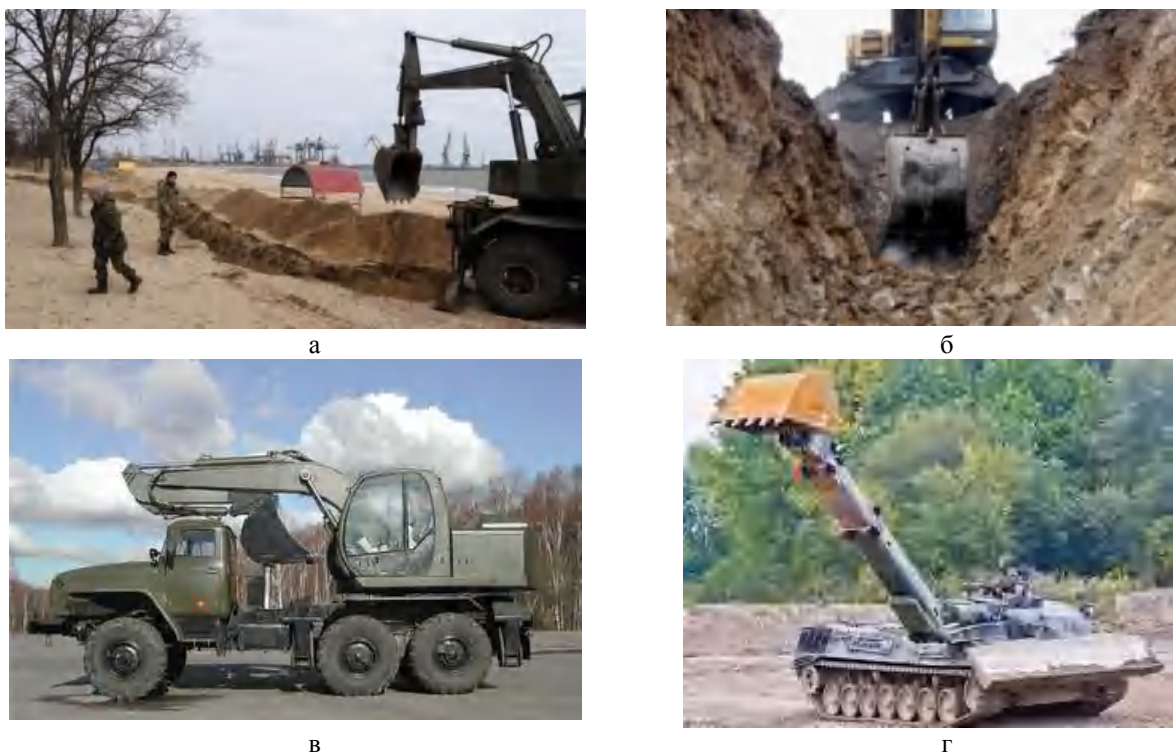
Рис. 5. Однокішцеві екскаватори на базі ходового обладнання: а, б, в – колісного; г – спеціального гусеничного.
