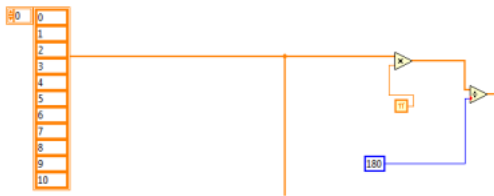
Рис. 3. Преобразование углов в радианы / Transformation of corners to the radians
