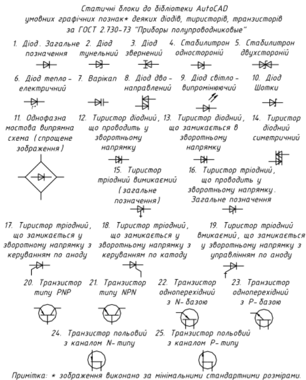
Рис. 3. Файл “Напівпровідникові елементи за ГОСТ 2.730-73 (сблоку).dwg” / File “Semiconductors State Standard 2.730-73 (static blocks).dwg”
