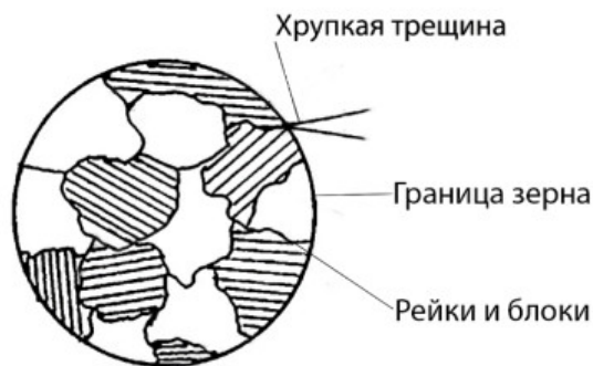
Рис. 1: Схематическое изображение участка микроструктуры стали.
