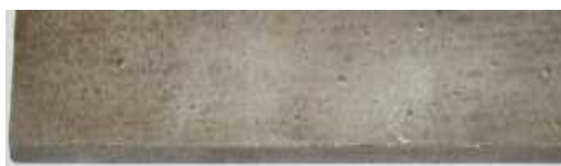
Рис. 3. Вид поверхности образца трубы из стали 06X1 (0,025% Nb) после испытаний на стойкость против водородного растрескивания по стандарту TM 0284, \times 4 / Appearance of surfaces of 06X1 (0,025% Nb) steel tubes after hydrogen embrittlement resistance tests carried out according to standard TM 0284
