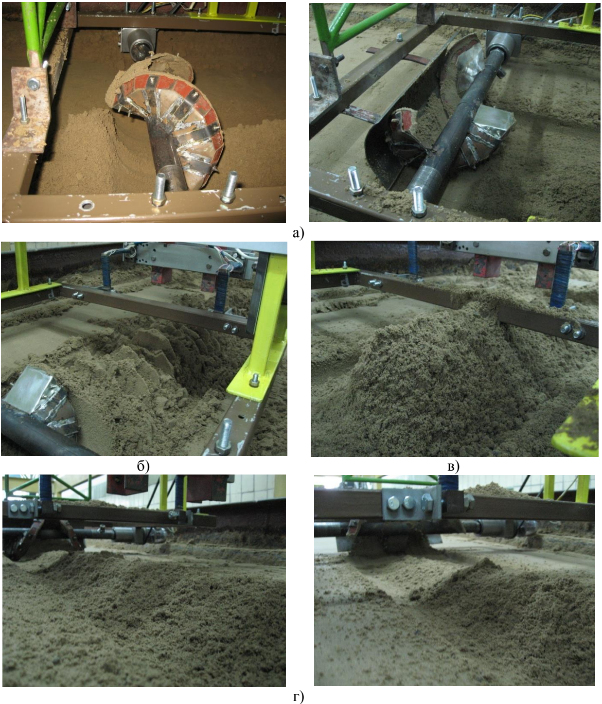
Рис. 2. Фотограми процесу копання ґрунту V_k=0.04 м.с.; D_{p.o.}=0,15 м.; S=0.15 м.; h_k=0,02 м.: а) з захисним кожухом; б) на докритичному режимі n=170 хв -1 ; в) на критичному режимі n=340 хв -1 ; г,д) на закритичному режимі n=410 хв -1 .
