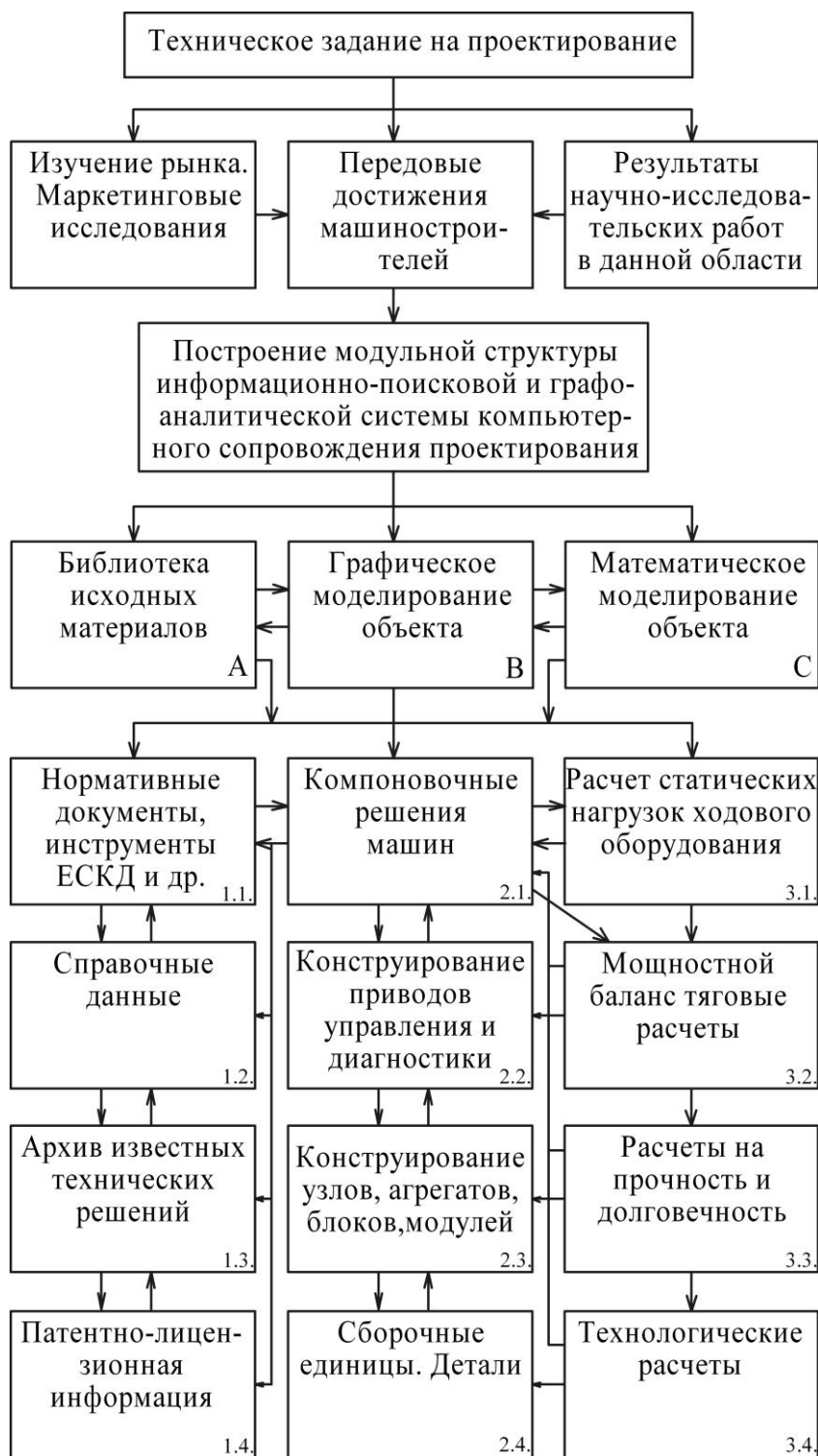
Рис. 1. Структурная схема одного из возможных алгоритмов выполнения операций ФТА с использованием компьютерных технологий.
