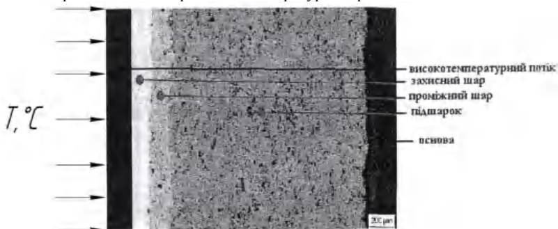
Рис 1. Блок – схема поперечного перерізу тришарового термозахисного покриття, яке отримано газотермічним напилюванням.
