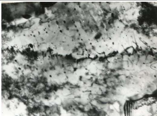
**Рис. 4.** Микроструктура арматуры D22 мм переходный слой, отпуск 550°С., ×18000
