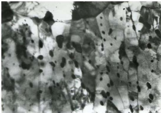
**Рис. 5.** Микроструктура арматуры D22 мм переходный слой, отпуск 650°С., ×18000
