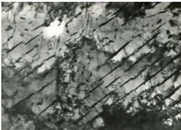
**Рис. 1.** Микроструктура арматуры D22 мм срединные слои стержня.  $\times 18000$
