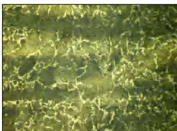
**Рис. 2.** Зависимость (а) и примеры расположения доэвтектоидного феррита во внутридендритных (1) и междендритных (2) участках в колесной стали после ГПД без ТО (б) и ГПД с ТО (в). б, в –  $\times 250$ , травлено пикратом Na
