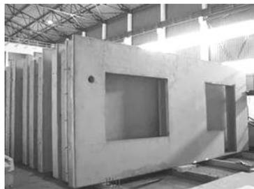
Рис.1. Трехслойные стеновые панели / Three-layered wall panels
