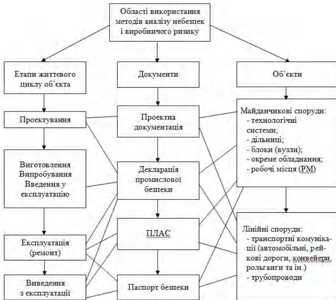
Рис. 1. Схема взаємозв'язків областей використання методів аналізу небезпек і виробничого ризику при розробці проектної документації / Scheme relationships regions using methods of hazard analysis and production risk the development of project documentation
