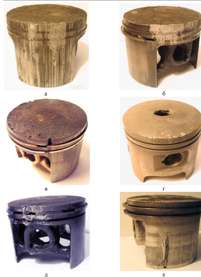
Рис. 1. Основные виды повреждений поршней из сплава АЛ25: а, б – задиры, следствие высокого коэффициента теплового линейного расширения; в, г – прогар поршня; д – механическое повреждение поршня вследствие разрушения поршневого или выпадения стопорного кольца; е – динамическое разрушение поршня.
