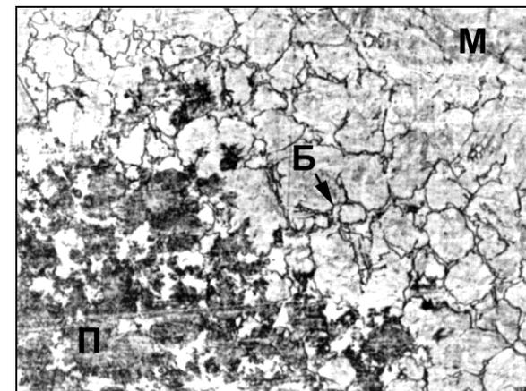
Рис.4. Микроструктура стали № 5 (охлаждение с  $V_{охл} = 0,5 \text{ } ^\circ\text{C}/\text{с}$ )  $\times 1000$
