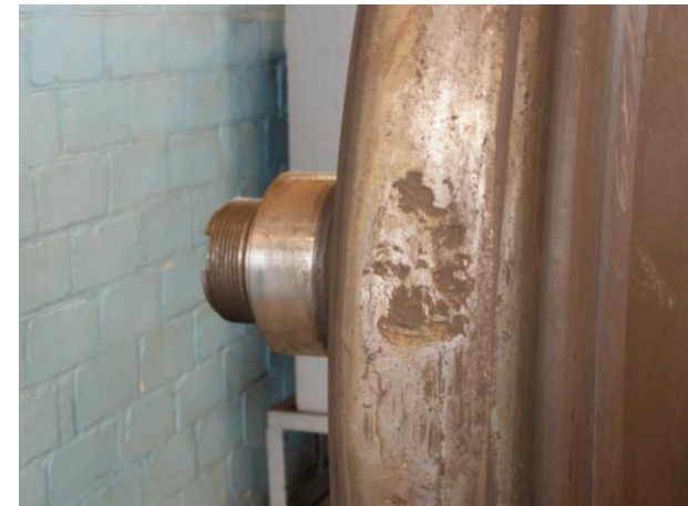
Рис.1. Зовнішній вигляд uszkodження по поверхні кочення залізничного колеса.
