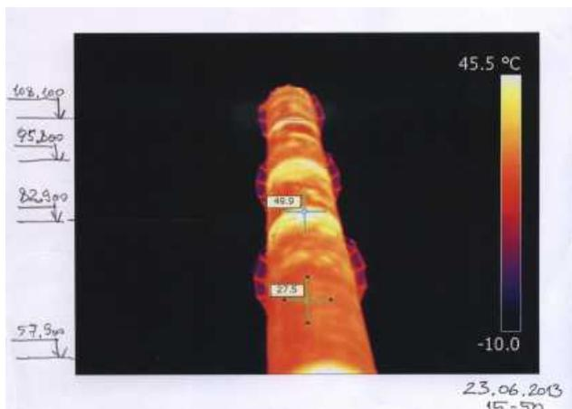
Рис. 2. Термограмма поверхности ствола железобетонной дымовой трубы после взрыва.
