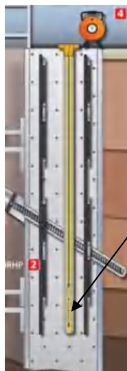
Рис. 1. Расположение инклинометрической системы для определения вертикального смещения грунта
