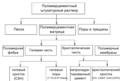
Рис.8. Структурная модель и структура полимерцементного штукатурного раствора
