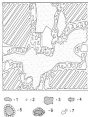
Рис. 6. Структура затвердевшего раствора 1.Непрогидратированные зерна цемента 2.Частицы полимера 3.Зерна мелкого заполнителя и наполнителя 4.Смесь непрогидратированных частиц цемента и цементного геля с осажденными на их поверхности частичками полимера 5.Смесь цементного геля и непрогидратированных частиц цемента окруженным упакованным слоем полимерных частиц, 6.Гидраты цемента, окруженные полимерными пленками или мембранами. 7.Вовлеченный воздух.
