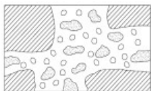
Рис. 2. Структура полимерцементного штукатурного раствора после смешивания с водой 1. Непрогидратированные зерна цемента 2. Частицы полимера 3. Зерна цемента мелкого заполнителя и наполнителя
