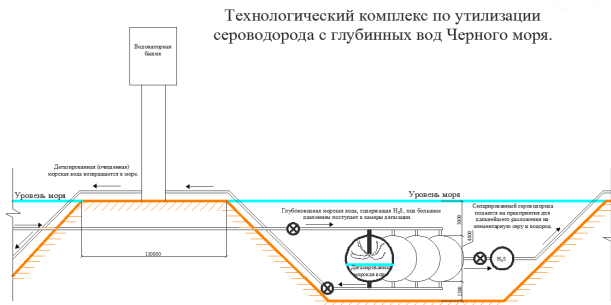
Рис. 3. Схематическое изображение комплекса по утилизации сероводорода из глубин Черного моря, который располагается на суше
