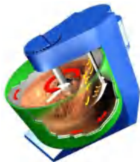
Рис. 4. Интенсивный смеситель (АЙРИХ) с вращающимся смесительным резервуаром для транспортировки смеси и смесительным инструментом с регулируемыми от высоких до низких скоростями
