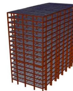
Рис.4. Аксонометрическая схема железобетонного каркаса
