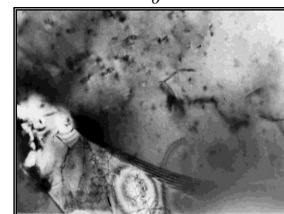
Рис. 2. Морфология продуктов превращения стали 08Г2С аустенитизации, изотермической выдержки 7 мин при 600°C, отпуска 600°C в течение 30 мин.
