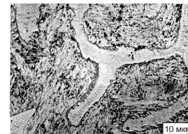
Рис. 2. Микроструктура опытной стали (плавка №6). Полирование окисью хрома, травление в реактиве Марбле.
