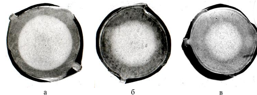
Рис. 1. Макроструктура арматуры стали 25Г2С, упрочненной на уровне прочности а) \sigma_B = 920 Н/мм 2 ; б) \sigma_B = 1070 Н/мм 2 , в) \sigma_B = 1060 Н/мм 2
