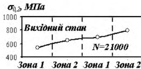
Рис. 5. Розрахункові значення границі текучості металу ЗТВ сталі 10Г2ФБ до і після циклічного навантаження / Calculated values of fluidity limit of HAZ metal of 10G2FB steel before and after cyclic loading
