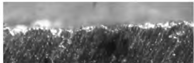
Рис.3. Характер нерівностей отриманих абразивним матеріалом корундом після першої пневмообробки. Figure 3. The nature of the inequalities obtained abrasive corundum after the first air training.
