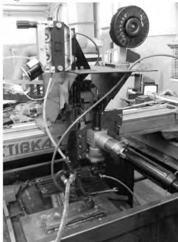
Рис. 1. Технологическая схема (a) и лабораторный стенд (b) для проведения экспериментов по лазерной и гибридной лазерно-дуговой сварки высокопрочных сталей / Technological scheme (a) and laboratory stand (b) to carry out experiments on laser and hybrid laser-arc welding of high strength steels
