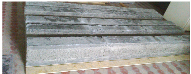
Рис. 1. Опытные образцы трехслойных балок / Prototypes of sandwich beams
