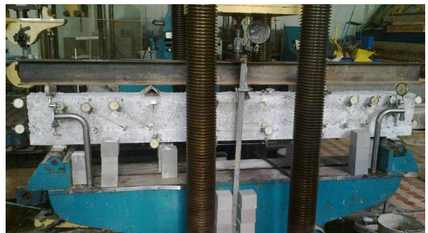
Рис. 2. Общий вид стенда для испытания балочных образцов в лабораторных условиях / General view of the test bench for beam specimens in the laboratory
