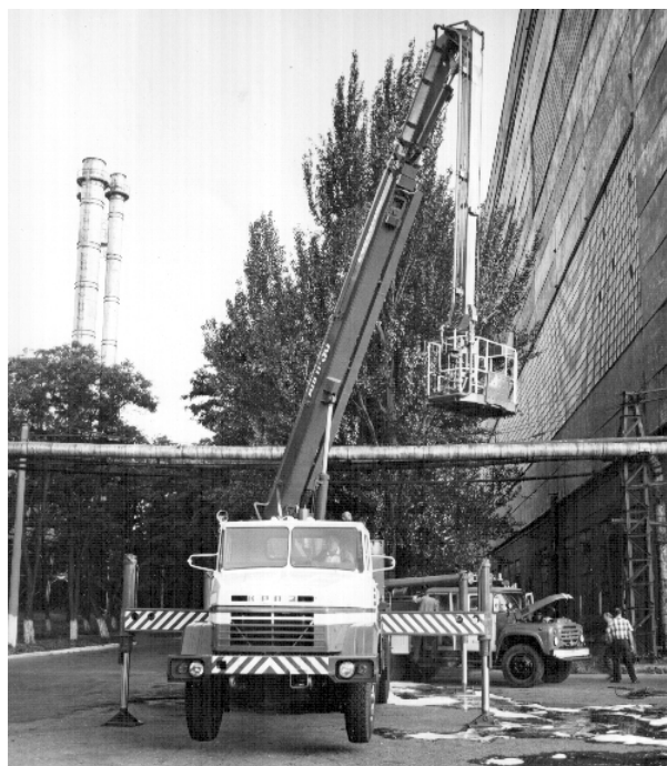
Рис. 1 – Момент разворачивания АППП-30 (производство з-да НКМЗ), установленного на аутригерах вблизи условно аварийного здания / The moment of deployment in fighting condition APGP-30
